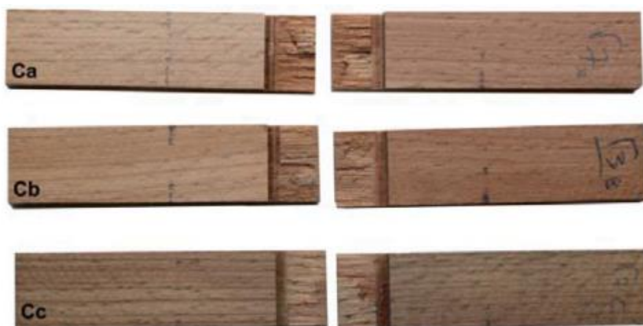
شکل ۲. نمونه های راش از چسب C و از سه فرآیند مختلف کاربردی (a. تهویه ۷ روزه در هوای استاندارد، b. تهویه ۷ روزه در هوای استاندارد، c. تهویه ۷ روزه، d. تهویه ۷ روزه در آب - تهویه ۷ روزه). پس از خرابی در آزمایش مقاومت برشی.
