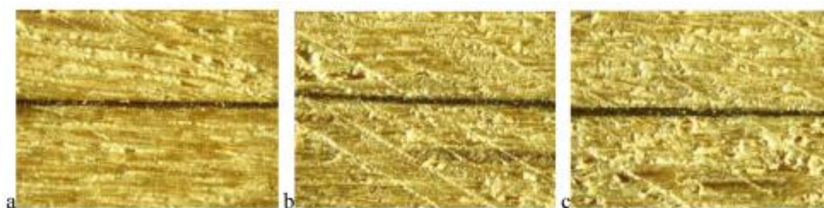
شکل ۴. خطوط باریک پیوستگی در اتصالات رویهم چسب E (با بیشترین دوام) پس از ۷ روز تهویه (a) ۷ روز در هوای استاندارد + ۳ ساعت در آب (20 \pm 5^\circ \text{C}) + ۷ روز در هوای استاندارد (b) و ۷ روز در هوای استاندارد + ۴ روز در آب (20 \pm 5^\circ \text{C}) + ۷ روز در هوای استاندارد (c)، (x48).
